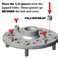
NOTE: COUNTER BORES ON ROTOR SHOULD BE FACING UP.
